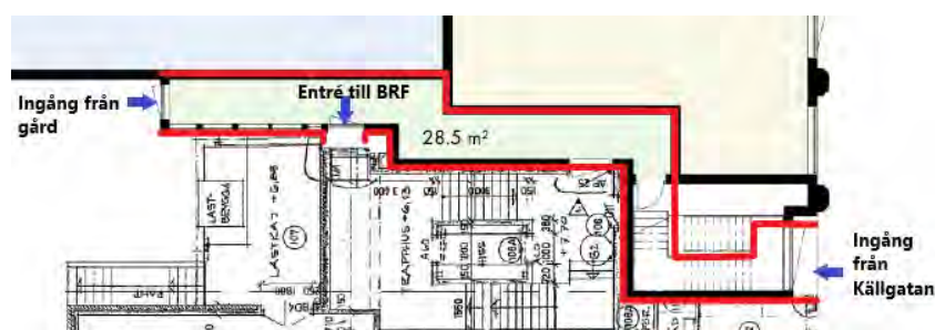
Bilden visar den föreslagna passagen genom den nya hotellbyggnaden till befintligt bostadshus på grannfastigheten.
